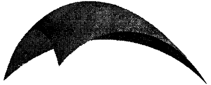
Рис. 3.11.4. Треугольная поверхность на трех дугах окружности
